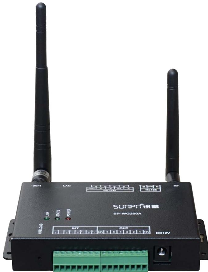
SP-WG200A网关，使用配置软件配置好网关挂载子设备的相关参数后，网关自动和挂载设备通讯，并把挂载的设备数据封装成JSON格式数据，并以设定的周期时间或者数据发生变化自动上传至服务器。
